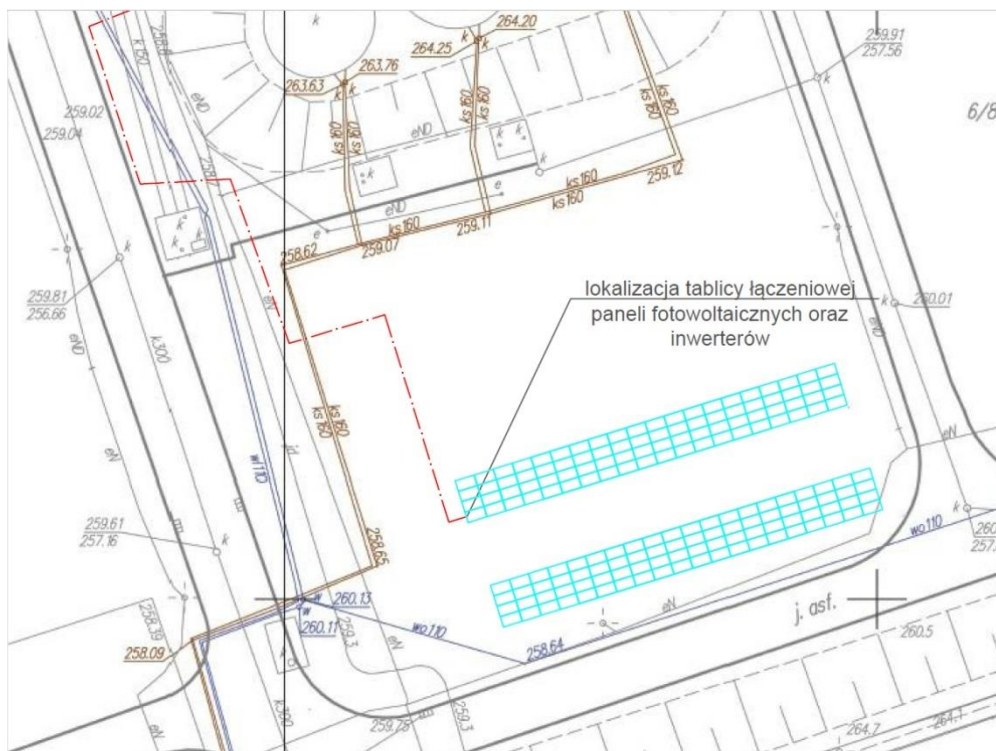
Rysunek 2 Usytuowanie modułów fotowoltaicznych dla instalacji 48,64 kWp.
