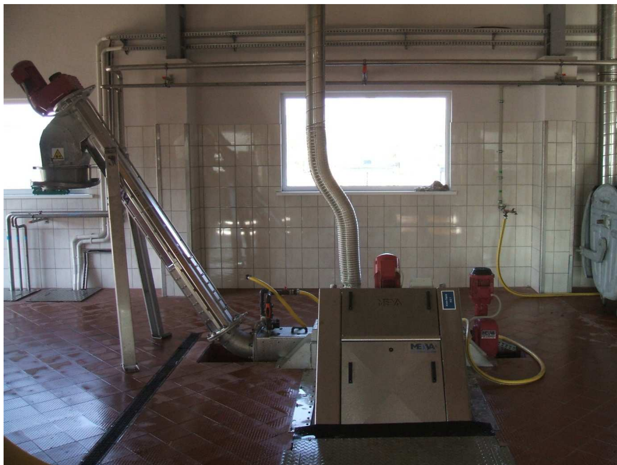
Rys. 6. Widok układu hermetyzacji krat.
