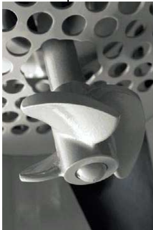
Rys. 14. Dodatkowy wirnik do wzburzania piasku.
