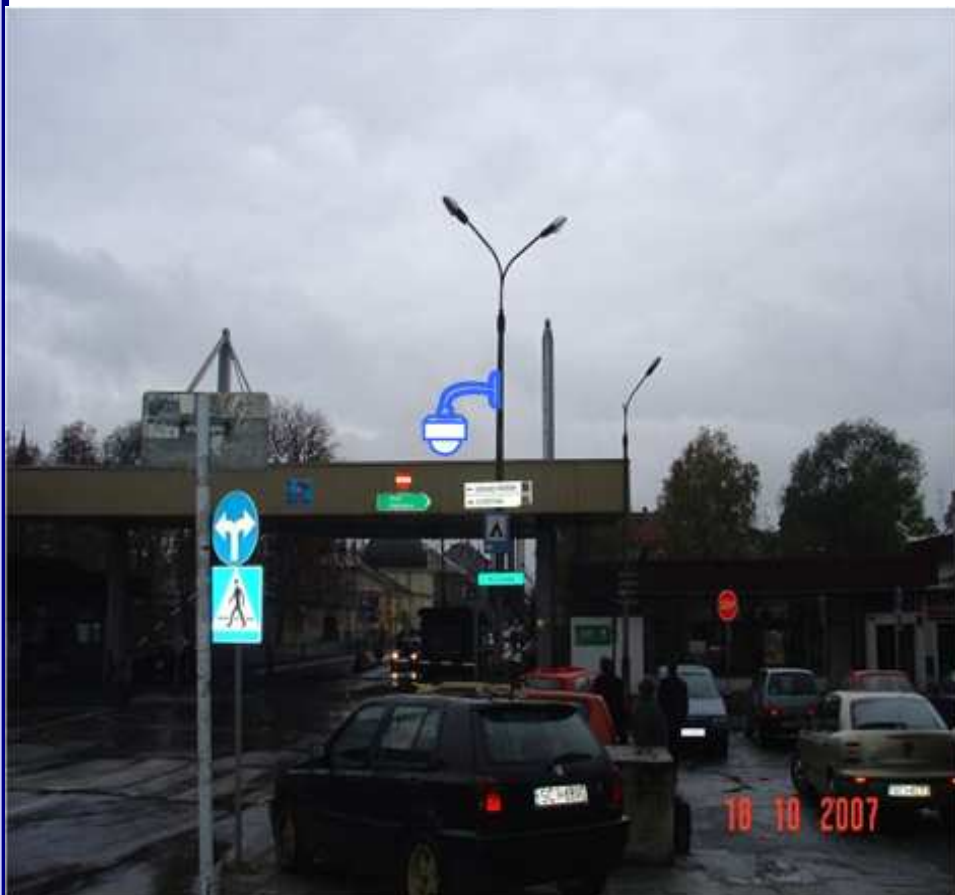
Słup oświetlenia ulicznego, kamera zamontowana na wysokości min 5 m
